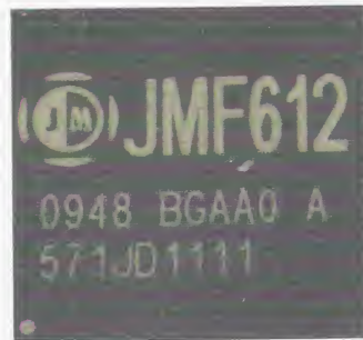
Рис. 3. Контроллер JMicron JMF612
